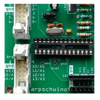
Enfin les connecteurs HE10 pour les nappes. La fente doit être tournée vers l'intérieur de la carte. Comme pour les circuits intégrés, commencez d'abord par les 2 extrémités et vérifiez avant de souder les autres pattes.
