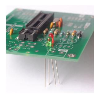
Les leds sont polarisées, une patte est plus courte et il y a un petit méplat sur le corps de la led. Mettre le méplat dans le même sens qu'indiqué sur la sérigraphie. Sur l'arpschuino<sup>2</sup><sub>R4</sub>, les méplats (et les pattes courtes) sont tournés vers le connecteur d'alimentation. Grande patte dans la pastille carrée.
