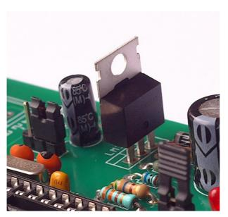
Attention au sens aussi pour le régulateur lm317, le côté semelle est indiqué sur la sérigraphie. Si vous avez l'option pré-régulateur, ne le confondez pas avec le 7810.
