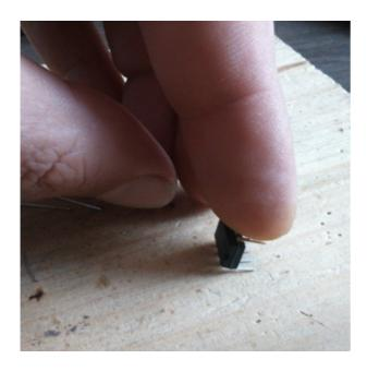
Il ne reste plus qu'à clipper les circuits intégrés (sn65hvd08P et ATmega 328).
