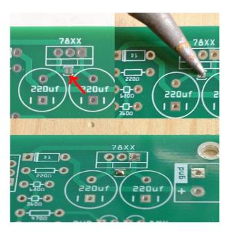
Depuis la version R6 de l'arpschuino<sup>2</sup>, un (pré)régulateur de tension peut être monté en option. Si vous n'avez pas choisi cette option, faites un pont de soudure entre les deux pads indiqués sur la photo.
