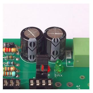
Les condensateurs chimiques sont polarisés. La bande blanche (-)doit être tourné vers l'intérieur de la carte, donc la patte courte dans la pastille carré, contrairement au leds. Attention un condensateur chimique monté à l'envers peut exploser! Sans grand danger mais ça surprend!
