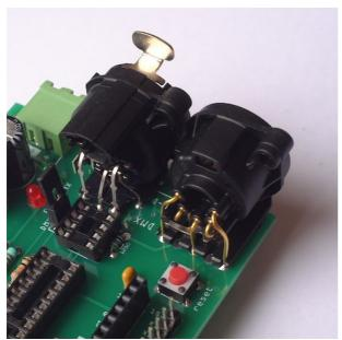
Vous pouvez maintenant souder les XLR. Le circuit imprimé permet de monter au choix des XLR 3 ou 5 broches. Il est donc normal que des trous ne soient pas utilisés.
